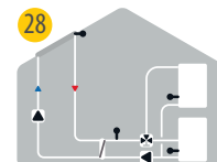
28 Solare con scambiatore e 2 accumuli
