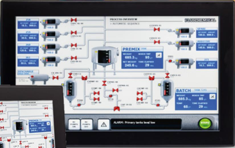
La funzionalità Server e client OPC UA e il supporto integrato di vari broker MQTT che utilizzano il protocollo MQTT facilitano l'utilizzo della serie EH-TP700 all'interno di varie soluzioni IoT.
