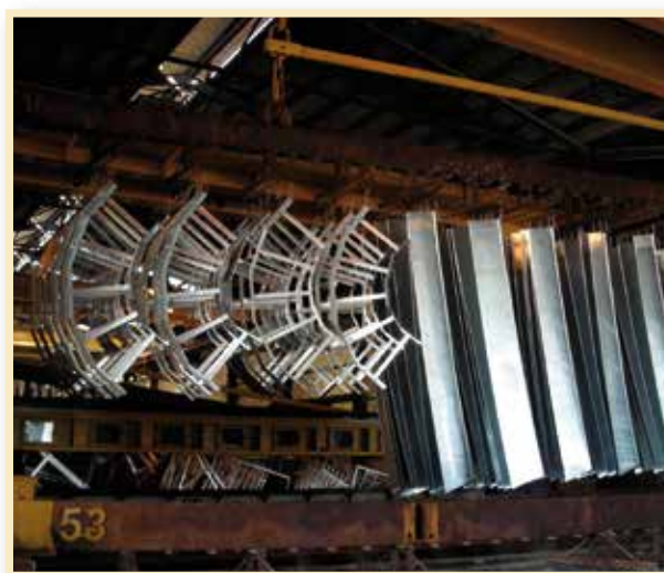
Fasi di lavorazione della zincatura a caldo per immersione dopo lavorazione Hot dip galvanization phases following processing Phases de traitement de la galvanisation à chaud par immersion après l'usinage
