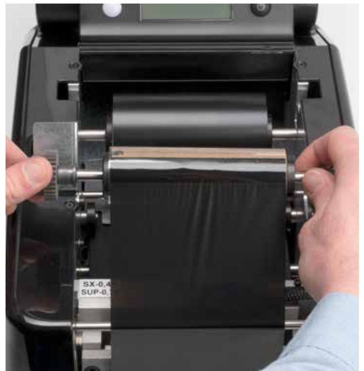
Avvolgimento e bloccaggio del nastro sul supporto anteriore
